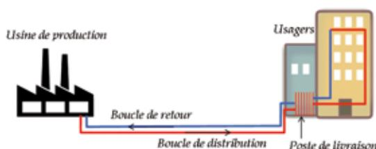
La chaleur est produite au niveau de centrales de production qui mettent à bonne température le fluide caloporteur. Pour cela, plusieurs sources d'énergie sont envisageables : fioul, gaz, biomasse, énergie fatale de site industriel ou d'incinérateur de déchets.
